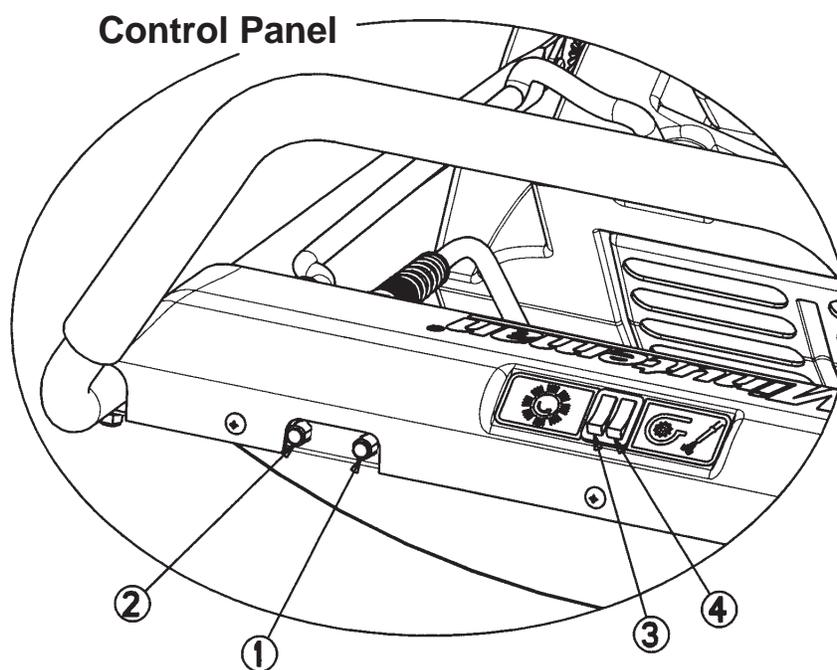
1. CIRCUIT BREAKER - BRUSH MOTOR - 3A (120 VAC) - 1.5A (240 VAC)
